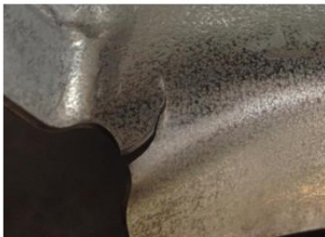
(In-Plane) Edge Stretching
